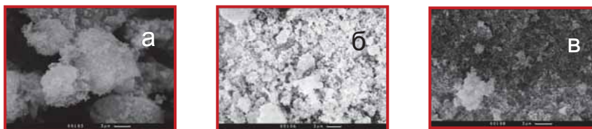
Рис. 7. Микрофотографии порошков гидросиликатов кальция, полученных методом осаждения из водных растворов \text{Na}_2\text{SiO}_3 и \text{CaCl}_2 без модифицирующих добавок (а), в присутствии ионогенного ПАВ (б), из микроэмульсий « \text{Na}_2\text{SiO}_3 в воде – соль ЧАО в толуоле» и « \text{CaCl}_2 в воде – соль ЧАО в толуоле» (в)
