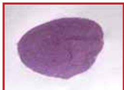
Рис. 8. Прекурсор, полученный в результате адсорбции карбоксилата Со на комбинированном минеральном носителе
