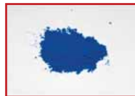
Рис. 9. Ультрадисперсный алюмокобальт-оксидный пигмент на основе мезопористого ксонотлита, полученный с применением экстракционно-пиролитического метода
