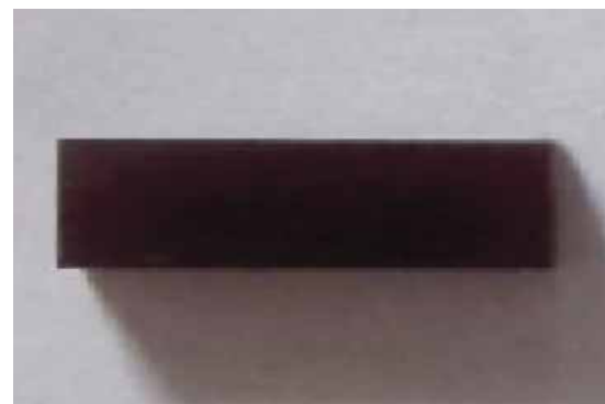
Рис.1 Стандартный образец наночастиц Au, со средним диаметром 3,5 нм. Концентрация наночастиц в СО составляет 1 мас. %.
