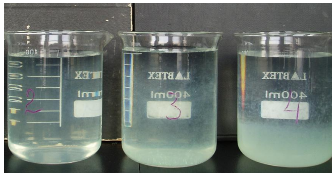
Рис. 4. Кинетика удаления ионов никеля из водного раствора при осаждении гидроксида никеля (слева) и фотографии этого процесса на 10 минуте (справа): без добавок (2), с неактивированной (3) и активированной (4) добавкой NiSiO 3 .
