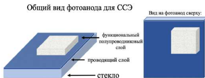
Рисунок 3.3. Общий вид заготовки фотоанода, подложка с проводящим слоем и сформированным слоем диоксида титана.
