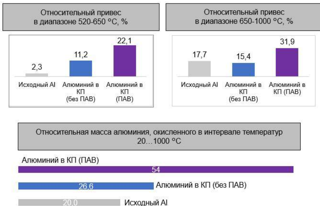
Рисунок А.1 – Ключевые показатели высокотемпературного окисления алюминия в составе композиционных порошков, полученных после обработки в растворах SPAN-80
