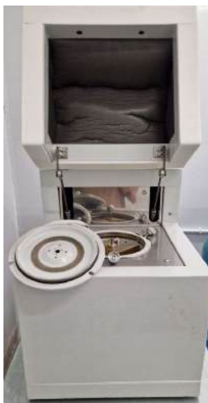
Рисунок 4 – Внешний вид мельницы-активатора «АГО-2У»
