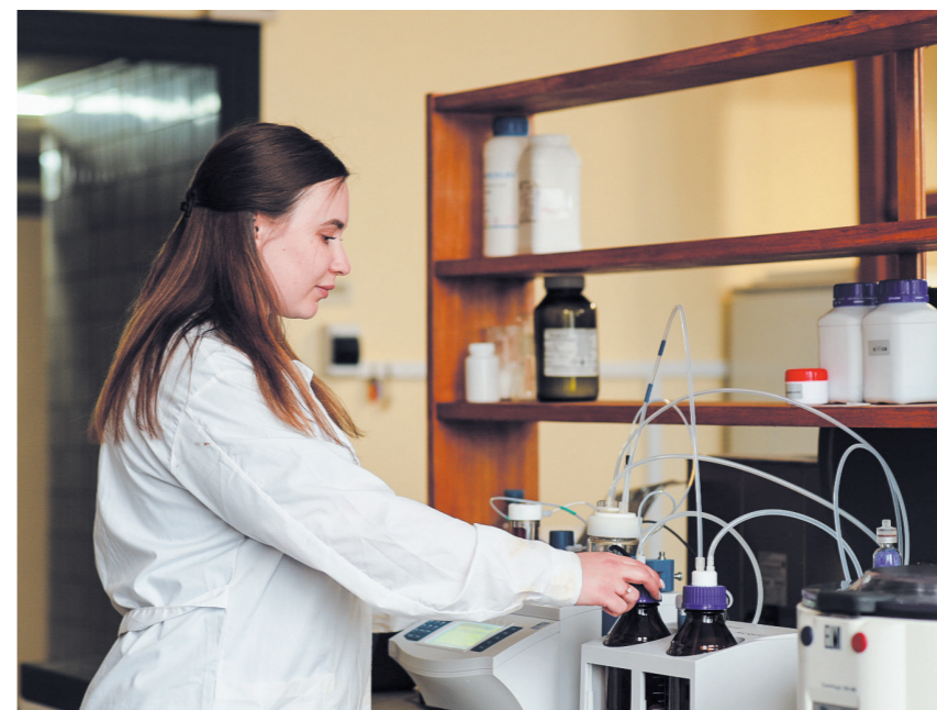
(а) Младший научный сотрудник Арина Милевская определяет содержание воды на титраторе Фишера. Источник: Анна Киреевко
