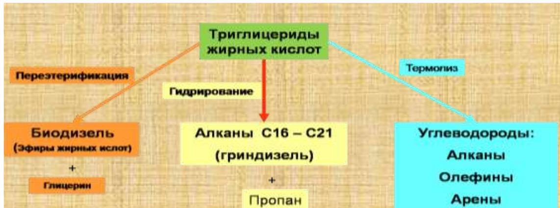
Сверхкритическая технология переэтерификации. Получение биодизеля.
