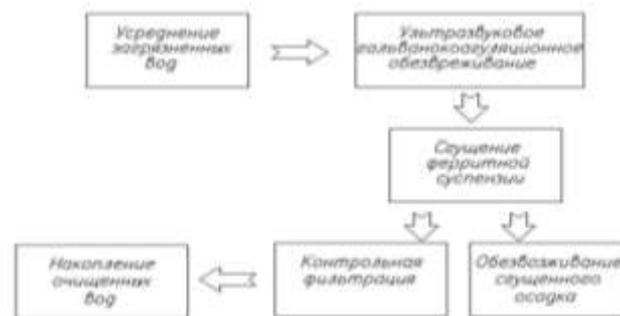
Блок-схема УЗ ГК очистки загрязненных вод участка мойки вагонов
