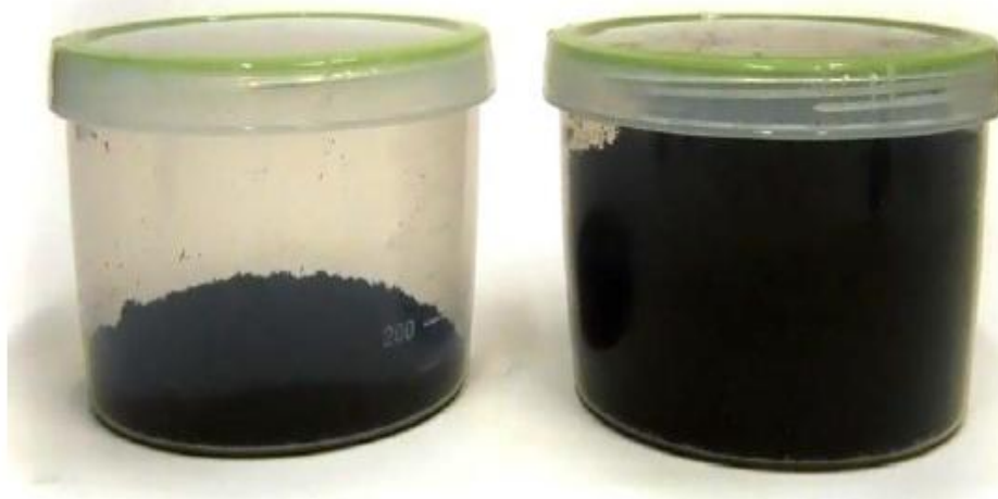
Рисунок 5. Внешний вид порошка ОУНТ (~ 1г) до (слева) и после (справа) RESS-обработки.
