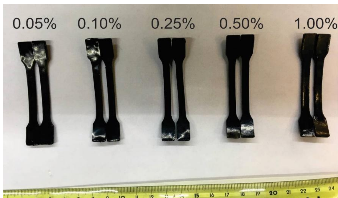
Рисунок 26. Фотографии «лопаток», приготовленных из композитов с обработанными ОУНТ методом RESS, TPU- полиуретан (А) и с не обработанными (Б) при разных концентрациях нанотрубок.
