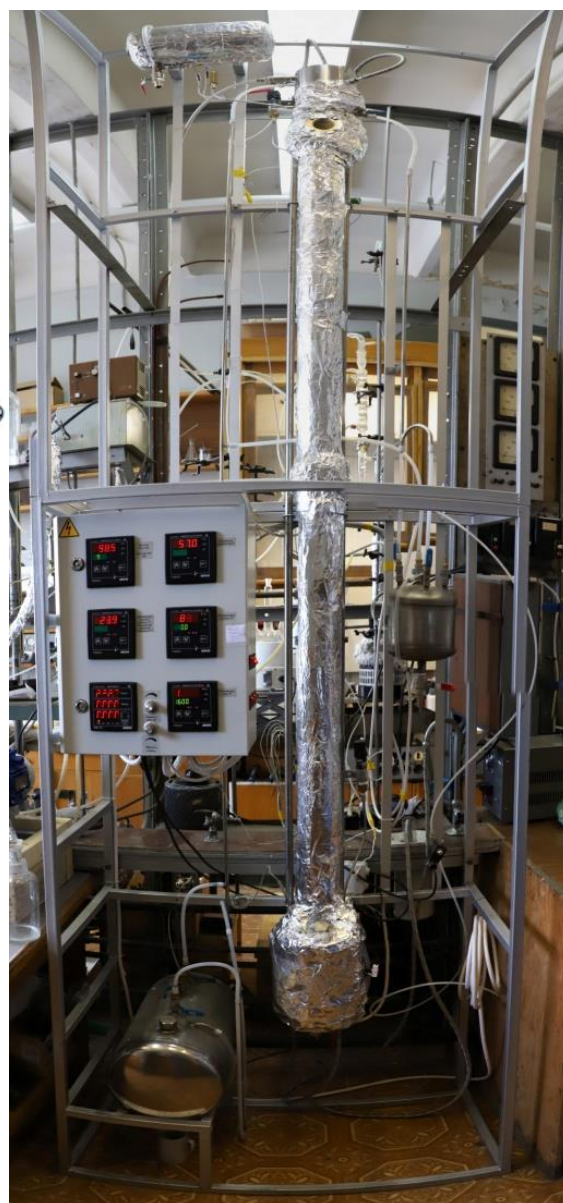
Рисунок 3.1. Типовая ректификационная колонна периодического действия: 1 – куб, 2 – обмотка электрообогрева, 3 – теплоизоляция куба, 4 – вентиль для слива кубовой жидкости, 5 – трубка для определения уровня жидкости в кубе, 6 – штуцер, 7,8,9 – CLAMP соединения, 10, 11 – насадочный слой, 12 – теплоизоляция насадочного слоя колонны, 13 – распределитель жидкости, 14 – смотровое окно, 15 – задержка жидкости в дефлегматоре, 16 – вентиль для отбора дистиллята, 17 – дефлегматор, 18 – градуированная трубка для замера расхода флегмы, 19 – вентили, 20 – трубка для определения уровня жидкости в приемнике дистиллята, 21 – приемник дистиллята, 22 – вентиль для слива дистиллята; Т и Р – точки измерения температуры и давления.
