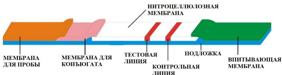
Рисунок 2 — Схематическое изображение иммунохроматографической тест-полоски
