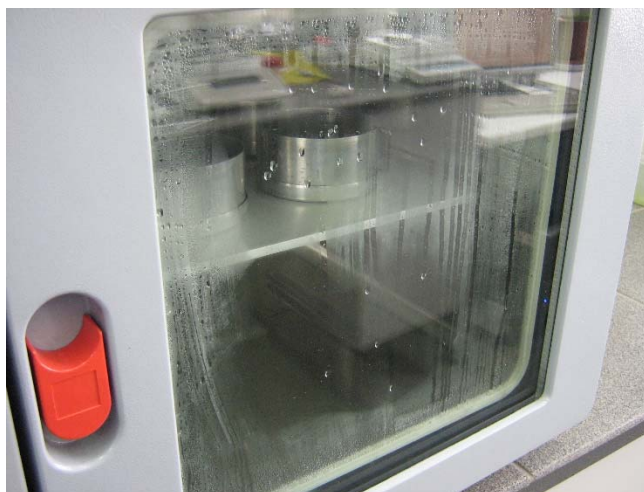
Рис. 4.14 – Внешний вид окна вакуумной сушильной камеры в процессе сушки в токе азота
