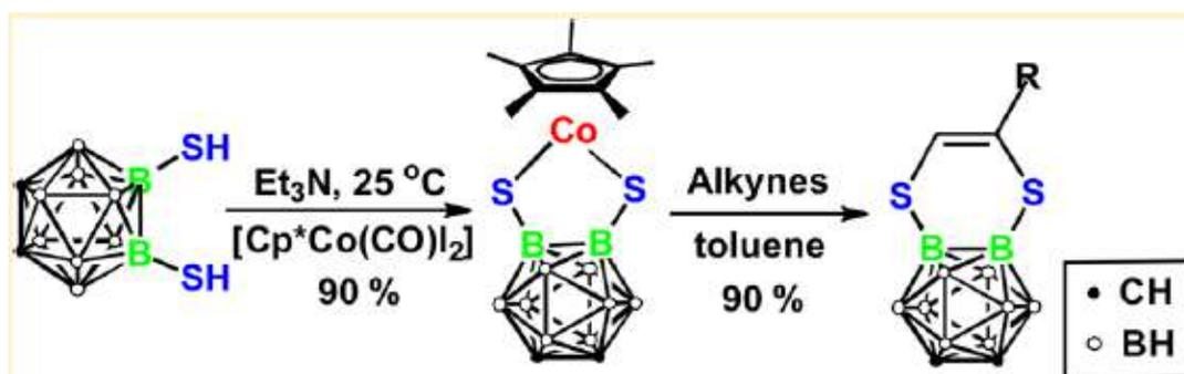
Рис. 35. Схема получения дитиокарборан пентадиенилкобальта и дальнейшее замещение металл-органического фрагмента
