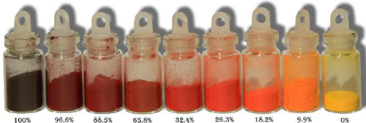
Рисунок 40. Серия твердых растворов [\text{Pu}_2(\text{XK})]_2[\text{Bi}_2\text{Br}_{10-x}\text{I}_x] . Под каждым образцом указано содержание иода (мольные %) согласно данным EDX
