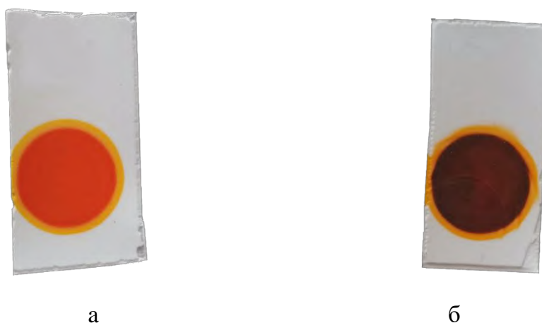
Рисунок 71. Результат нанесения раствора 34 в ДМФА на подложку из \text{SiO}_2 без (а) и с (б) использованием антисольвента
