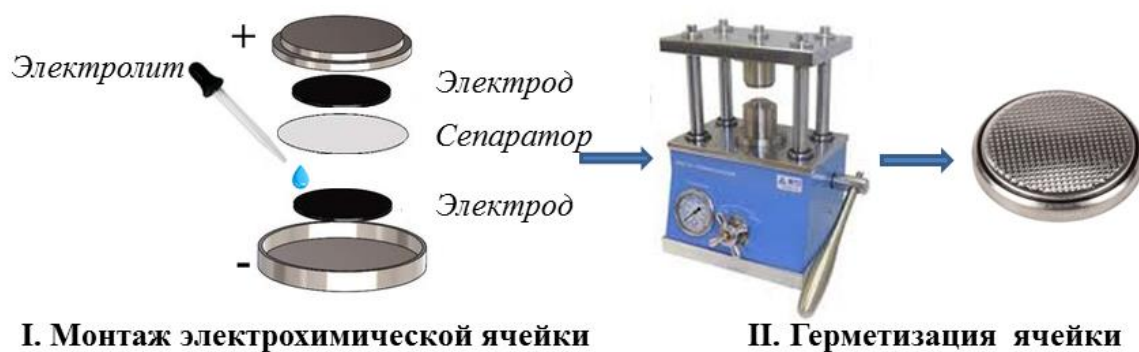
Рисунок 26 – Монтаж суперконденсатора по технологии «coin cell».
