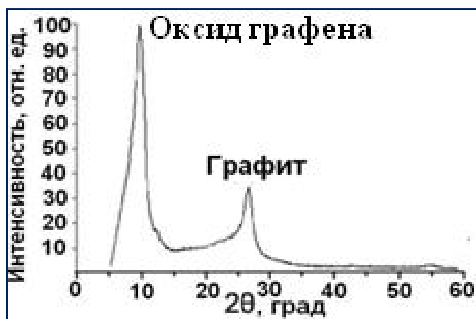
Рис. 7. Рентгенограмма оксида графена
