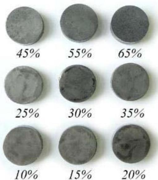
*Рисунок 279 – Внешний вид образцов ультравысокотемпературной керамики HfB<sub>2</sub>/xSiC (x=10÷65 об. %), полученных путем горячего прессования систем HfB<sub>2</sub>/x(SiO<sub>2</sub>-C)*
