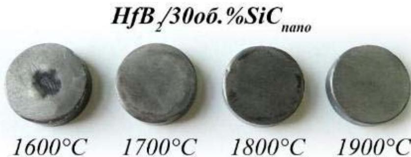
Рисунок 269 – Внешний вид образцов ультравысокотемпературной керамики  $HfB_2/30$  об. %  $SiC$ , полученных при различных температурах
