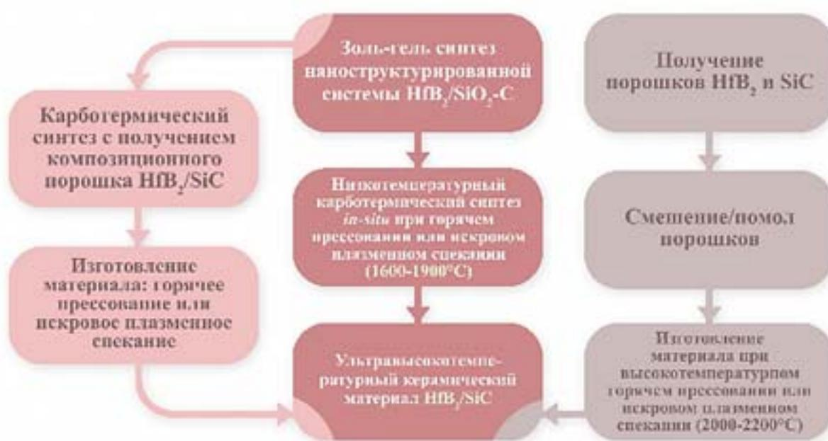
Рисунок 252 – Принципиальная схема предлагаемых подходов к изготовлению ультравысокотемпературных керамических материалов состава  $\text{HfB}_2/\text{SiC}$  (в центре и слева) и классического подхода (справа)
