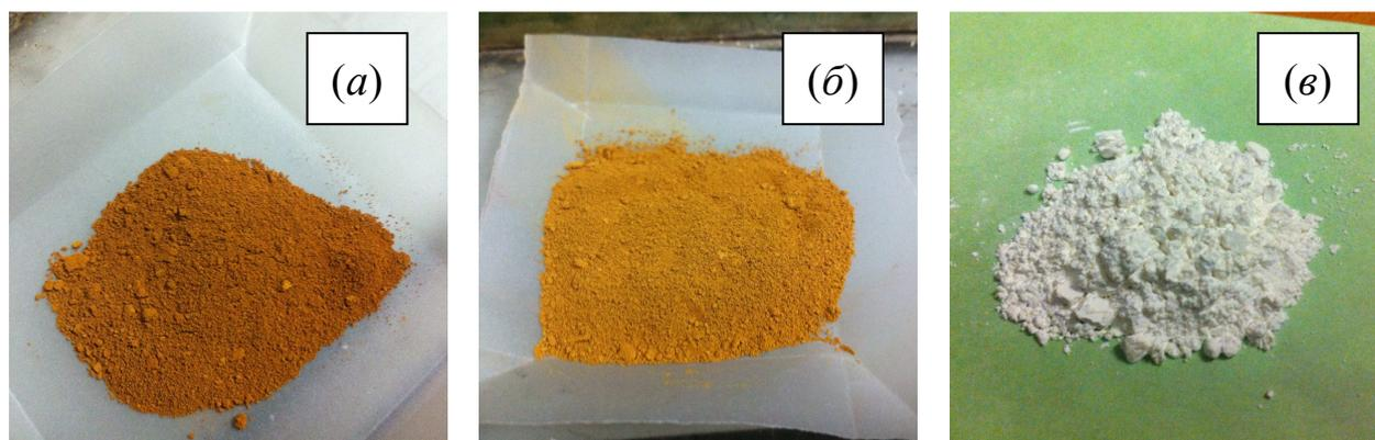
**Рис. 2.1** Фотографии порошков  $\text{Mg}(\text{Fe}_{1-x}\text{Ga}_x)_2\text{O}_4$  с  $x = 0.2$  (a),  $0.4$  (б) и  $1$  (в).
