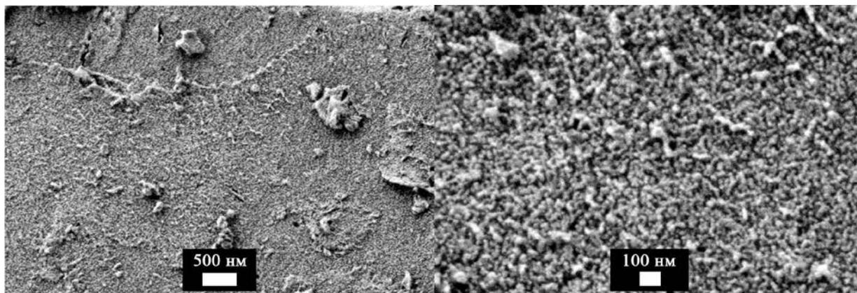
*Рис. 42 Микроструктура порошка TiC, полученного при 1400°C и выдержке в течение 4 часов в условиях избытка углерода в высокодисперсной смеси «TiO<sub>2</sub> – C»*
