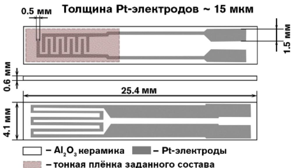
Рис. 21. Датчик, используемый в данной работе: подложка из оксида алюминия с нанесенными на неё платиновыми встречно-штыревыми электродами и микронагревателем с оборотной стороне
