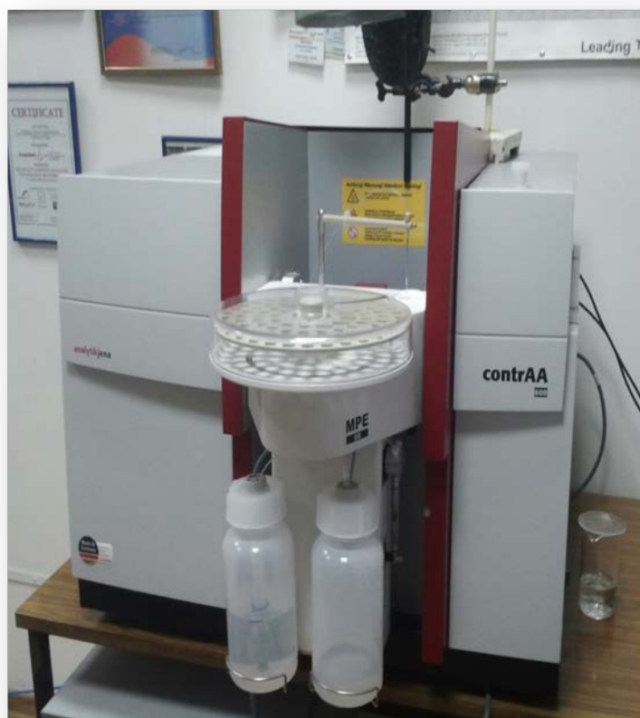
Рисунок 3 – Атомно-абсорбционный спектрометр высокого разрешения с непрерывным источником спектра серии contrAA (фирмы Analytik Jena)
