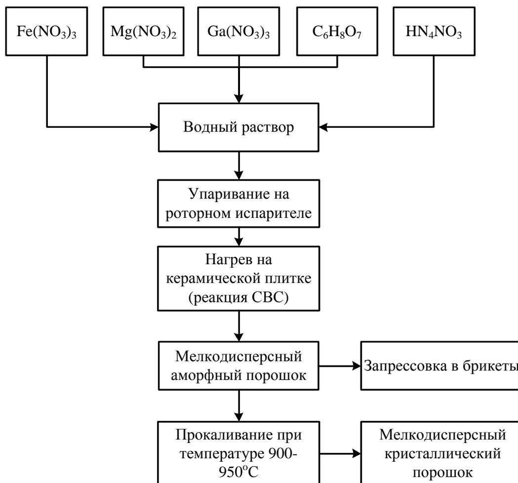
Рисунок 2.1 – Общая схема процесса синтеза керамических образцов  $\text{Mg}(\text{Fe}_{1-x}\text{Ga}_x)_2\text{O}_4$
