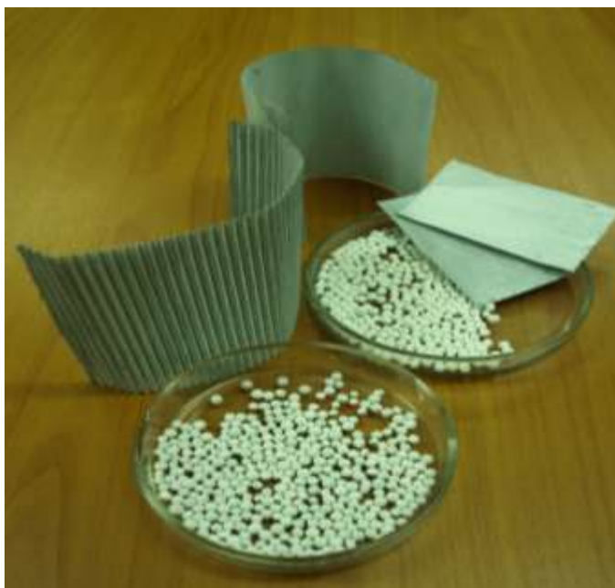
Рис. 4.18. Внешний вид образцов катализатора в виде сферических гранул, гладкой и гофрированной пластин
