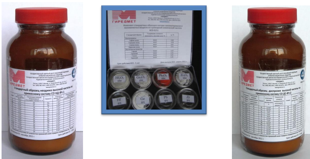
Рисунок 4 - Примеры разработанных и аттестованных стандартных образцов высокочистых веществ, предназначенных для практического использования.
