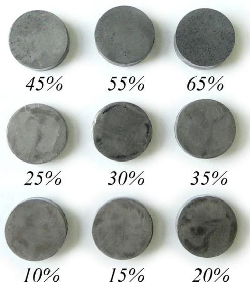
Рисунок 18 – Внешний вид образцов  $HfB_2/xSiC$  ( $x=10\div 65$  об. %), полученных при температуре 1800°C
