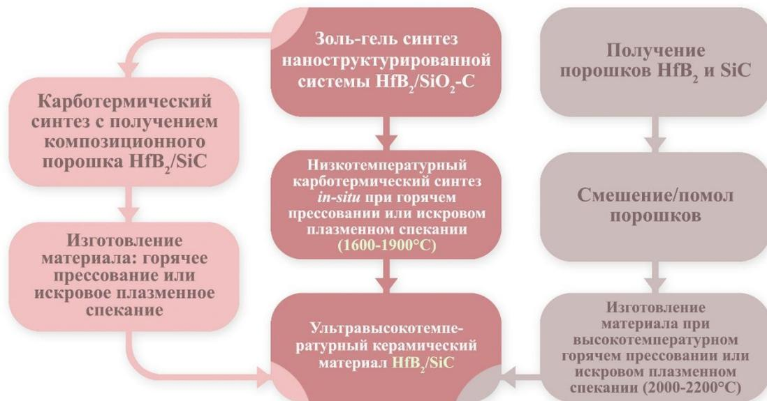
Рисунок 17 – Принципиальная схема предлагаемых подходов к изготовлению ультравысокотемпературных керамических материалов состава  $\text{HfB}_2/\text{SiC}$  (в центре и слева) и классического подхода (справа)
