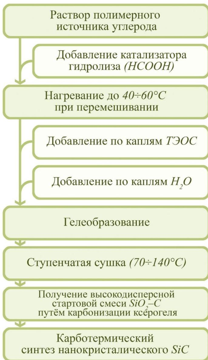
Рисунок 4 – Схема гибридного метода синтеза наноразмерного карбида кремния
