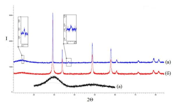
Рис. 2. Формирование структурного типа пирохлора у цирконата неодима: (а) - аморфный прекурсор, (б) - структурный тип флюорита после отжига при 1273 K, (в) - проявление структурного типа пирохлора после нагревания до 1723 K.
