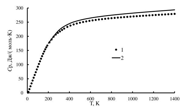
Рис. 5. Температурная зависимость теплоемкости  $Er_2O_3\cdot 2ZrO_2$ : 1 - адиабатическая калориметрия 6-340 К и ДСК 340-1400 К; 2 - оценка теплоемкости по правилу Неймана-Коппа.
