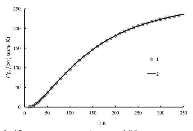
Рис. 4. Теплоемкость цирконата лантана: 1-наши данные, 2- [16].
