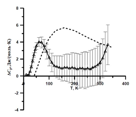
Рис. 7. Разность теплоемкостей  $(Sm_2Zr_2O_7-La_2Zr_2O_7)$ . Пунктиром показан вклад аномалии Шоттки для  $SmPO_4$  [18].
