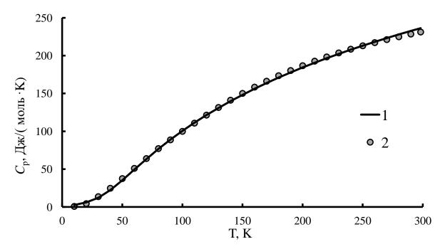
Рис. 6. Сравнение данных по теплоемкости цирконата самария: 1 - флюорит, 2 - пирохлор.
