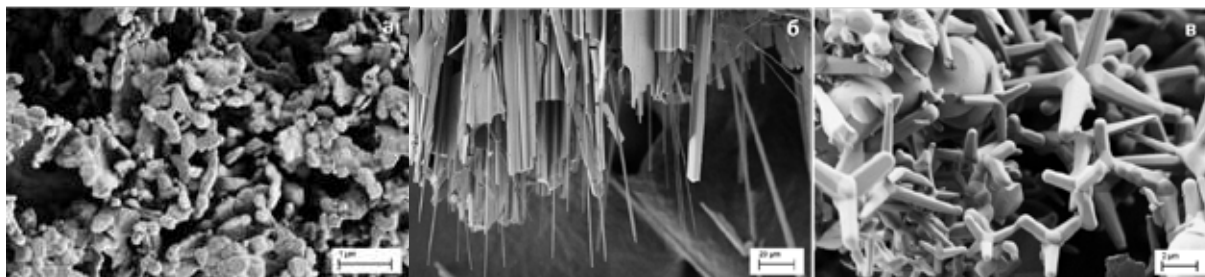
Рис. 1. СЭМ-изображения ZnO: сферы (а), нановискеры (б), тетраподы (в)
