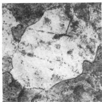
Фиг. 4. 95,94 % Pd; 4,06 % Re, отожжен; \times 100
