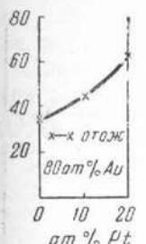
Фиг. 74. Твердость разреза с постоянным содержанием 80 ат. % Au
