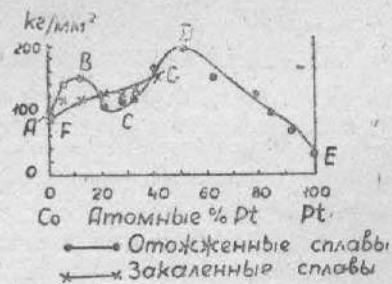
Рис. 17. Твердость по Бринелю отожженных и закаленных сплавов системы платина — кобальт — по В. А. Немилову
