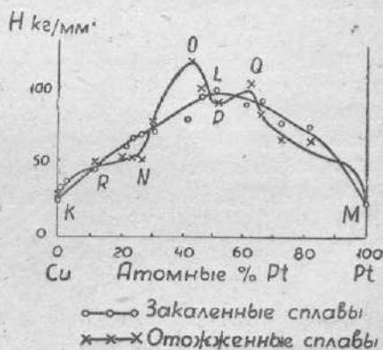
Рис. 8. Твердость по Бринелю отожженных и закаленных сплавов системы платина — медь — по Н. С. Куриакову и В. А. Немилову
