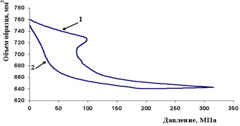
Кристаллизация 1,4-бутандиола при температуре 298К (изменение объема образца при повышении давления кривая 1, при дальнейшем уменьшении давления – кривая 2).
