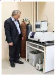
Дифрактометр «Smart Apex II» фирмы «Bruker»
