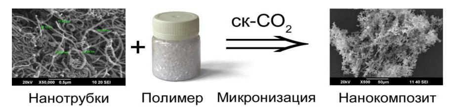
Разработан метод получения композитных материалов типа полимер - многостенные углеродные нанотрубки (МУНТ) методом сверхкритического антирастворителя.
