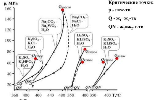
*P-Т проекция критических точек и критических кривых в трехкомпонентных водно-солевых системах.*
