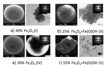
Рис.1. Гибридные мышьякселективные адсорбенты (ГМС) (а-в) и гранулированный неорганический материал для удаления мышьяка (ГНМС) (г)
