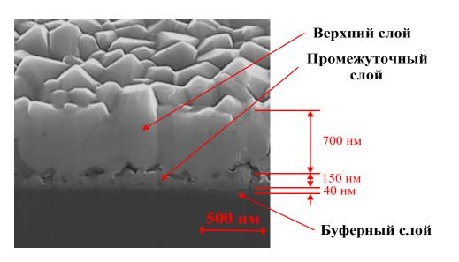
РЭМ- изображение поперечного сечения пленки состава  $Mg(Fe_{0,8}Ga_{0,2})_2O_{4-\delta}$  на Si
