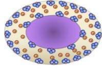
Наличие заряженных группировок изменяет распределение концентрации ионов (двойной электрический слой) и изменяет селективность транспортных процессов
