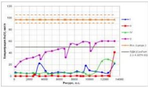
Рис. 3. Зависимость равновесной концентрации As(V) в фильтрате от ресурса (C (As) =  $97\pm7$  мкг/л, объёмная скорость фильтрации - 500 o.c./час, pH= $6,60\pm0,05$ )
