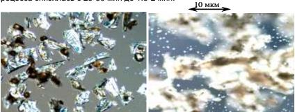
Микрофотографии частиц силиката кальция после ультразвуковой обработки (слева) и после осаждения на них карбоната кальция (справа).
