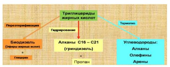
Сверхкритическая технология переэтерификации. Получение биодизеля.
