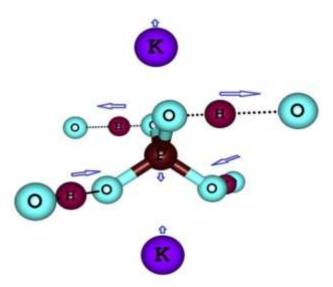
Рис. 1 Смещения «тяжелых» атомов в решетке KDP при сегнетоэлектрическом упорядочении
