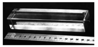
Разработана методика синтеза высокосовершенных кристаллов Bi<sub>4</sub>Ge<sub>3</sub>O<sub>12</sub> с повышенной радиационной стойкостью методом горизонтально направленной кристаллизации в атмосфере кислорода.
