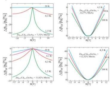
Синтезированы гранулированные наноструктуры на основе  ${\sf ZnGeAs}_2$  и  ${\sf CdGeAs}_2$  с  ${\sf MnAs}$ . Гигантское отрицательное магнетосопротивление было обнаружено в композите на основе  ${\sf ZnGeAs}_2$ , а положительное магнетосопротивление в нанокомпозитах на основе  ${\sf CdGeAs}_2$ . Изменение знака магнетосопротивления свидетельствовало о различной природе взаимодействия  ${\sf MnAs}$  в гранулированных структурах.
