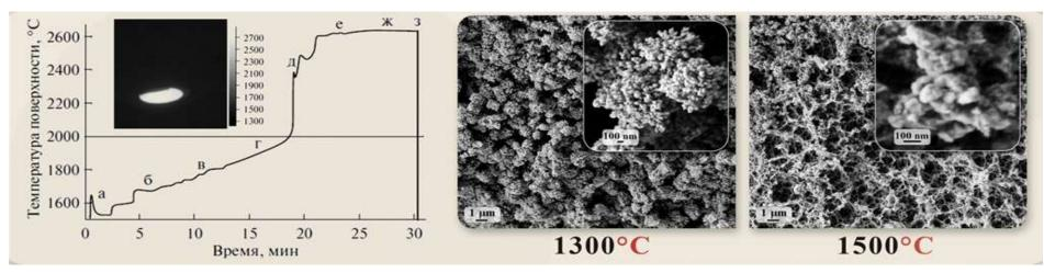
Получены сверхвысокотемпературные керамические композиционные материалы  $HfB_2$ —SiC, перспективные для современной авиакосмической техники, которые выдерживают воздействие потоков диссоциированного воздуха в течение 9-11 мин при температуре поверхности более 2600°C (совместно с ИПМех РАН и Институтом химии ДВО РАН).
