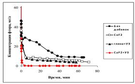
Кинетика удаления ионов фтора: с применением активированных частиц  $CaF_2$  содержание ионов фтора за 3 мин снижено с 100 до < 1 мг/л.
