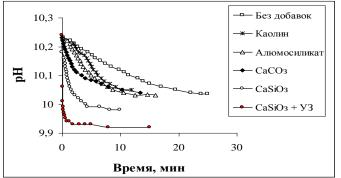
Максимальную скорость и глубину снятия пересыщения по  $CaCO_3$  обеспечивает добавка активированного  $CaSiO_3$  в концентрации 1 г/л. Продолжительность процесса снизилась с 25-30 мин до 1.5-2 мин.
