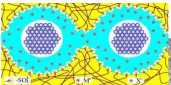
Внедрение наночастиц приводит к расширению пор и соединяющих их каналов, последние из которых определяют проводимость мембран.
