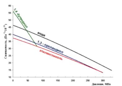
Барическая зависимость изотермической сжимаемости жидких диолов, воды и моноэтаноламина.
