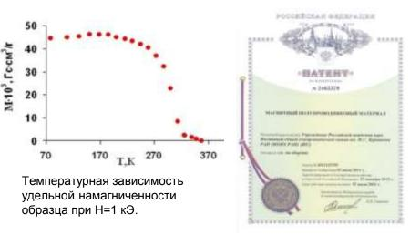
Синтезирован магнитный полупроводник на основе антимонида индия, легированного марганцем и цинком, с температурой Кюри Тс ≈ 320 К. Полевые зависимости намагниченности InSb ( Mn, Zn ), снятые при 4 и 260 К, указывают на то, что полученный материал является магнитомягким, с коэрцитивной силой не более 18 Э при Т = 300 К и может быть использован в устройствах, где требуется быстрое управление сигналом при минимальных затратах энергии.
